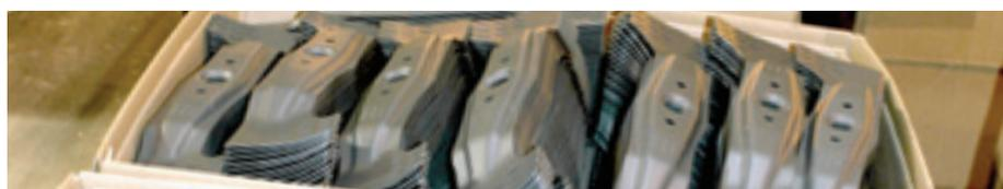
La production de lames de tondeuse ou débroussailleuse de qualité est un procédé complexe dont la maîtrise d'un bout à l'autre de la chaîne est très importante. En effet pour obtenir une lame à la fois dure mais non cassante, il est nécessaire de réaliser deux opérations importantes : formage à chaud avec trempe et revenu-peinture.
