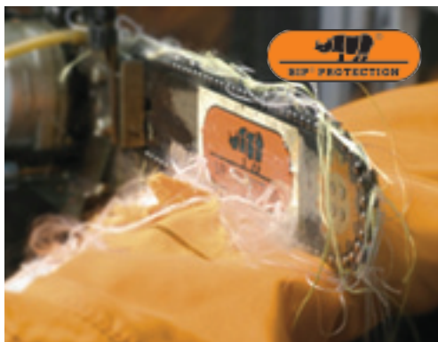
SIP® Protection Kleidung kann die Kette der Kettensäge immobilisieren oder abbremesen, wenn die richtige Schutzklasse gewählt wird
