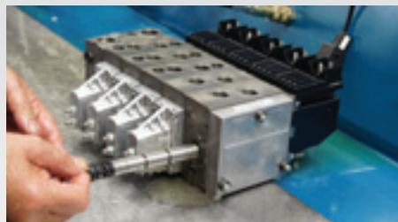
3. Entnehmen Sie den Kolben, und reinigen Sie ihn sorgfältig. Prüfen Sie, ob Laufspuren oder Beschädigungen vorliegen. Falls ja, ersetzen Sie den Kolben!
