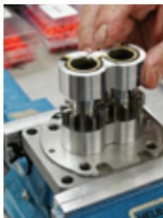
9. Drehen Sie die obere „Brille“ auf der Seite der hinteren Abdeckung horizontal um 180°, und setzen Sie sie wieder ein. Dabei muss der Stützring der Brille gut in der Aussparung liegen.
