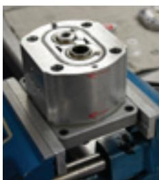
10. Drehen Sie das Pumpengehäuse vertikal um 180°. Montieren Sie es.
