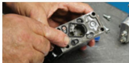
4. Kontrollieren Sie das Filtersieb im Magnetventil, und reinigen Sie es, wenn nötig.
