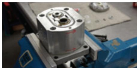
2. Legen Sie zunächst die Welle frei, indem Sie nacheinander die Schutzkappe, die Mutter, die Unterlegscheibe und den Keil entfernen.
