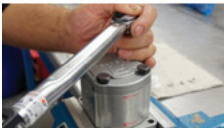
12. Drehen Sie die Schrauben ein, und ziehen Sie sie mit 45 Nm (Aluminiumabdeckung) bzw. 70 Nm (Gusseisenabdeckung) fest.
