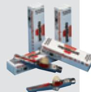
Der Optibelt TT mini nimmt die Kontrolle elektronisch vor. Dieses praktische Gerät verfügt über einen Messbereich von 5 - 500 Hz und garantiert schnelle und genaue Messungen. Setzen Sie mit dem Finger oder einem Gegenstand den Riemen in Schwingung; der TT mini misst dann die Schwingfrequenz. Vergleichen Sie den gemessenen Wert mit der erforderlichen Frequenz (siehe Optibelt-Dokumentation). So können Sie schnell und einfach feststellen, ob der Riemen die korrekte Spannung aufweist.
