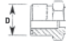
Filetage extérieur avec cannelure pour joint torique
